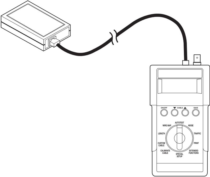
Fig. 4-2. Testing Twisted-Pair Cables.
