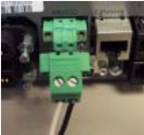
Battery Return (+) -48 VDC (-)
