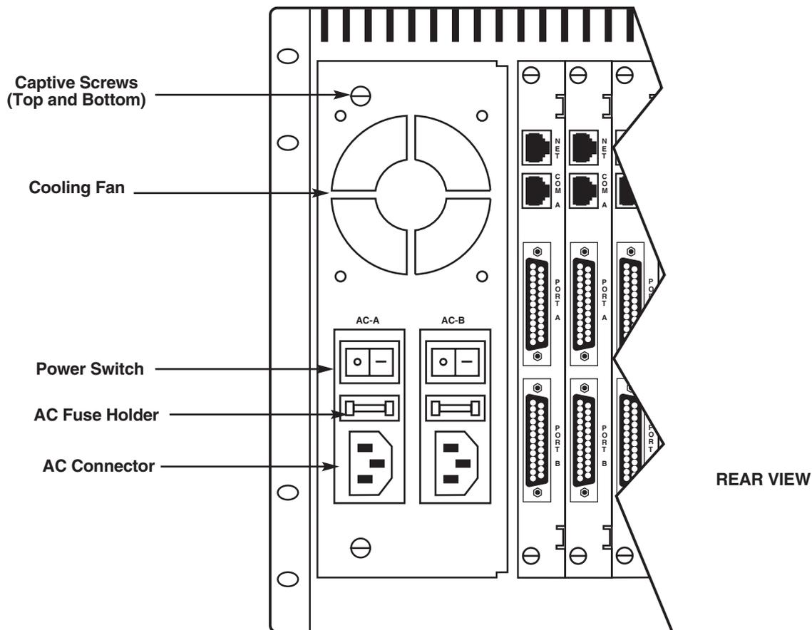
**Figure 2-3. AC Power-Connector Module.**
