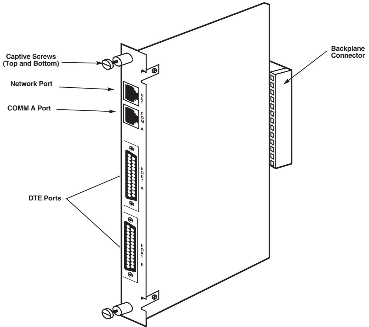
Figure 2-7. I/O-Interface Module.
