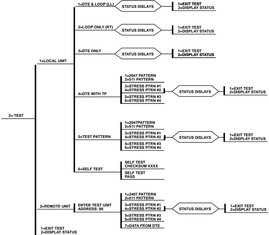
**Fig. 4-10. Complete Test Menu.**
