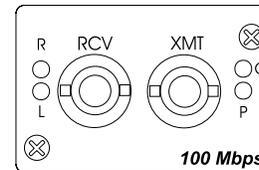
**Figure 2.8 100-Mbps Module, FX**
