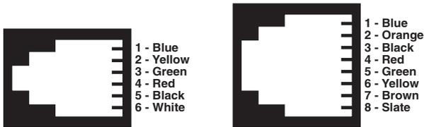
**Figure 4-2. AT&T® standard modular color codes.**
